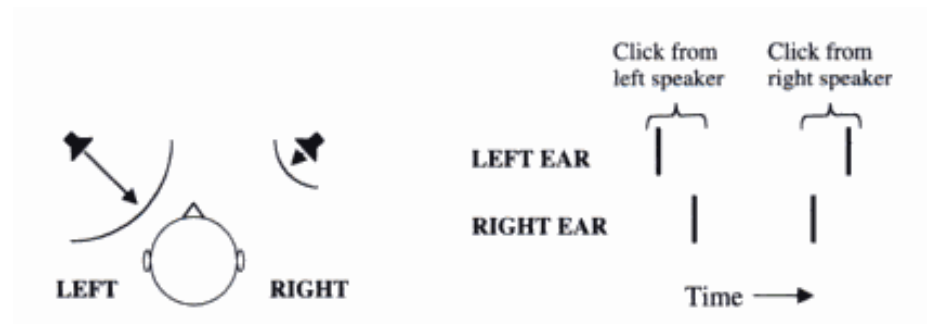
Obr. 11 Typická ukážka „precedence effect-u“. Klik z ľavého reproduktora dorazí k uchu skôr ako z pravého. Ak klik z pravej strany zaznie s oneskorením 1-5ms sluchový systém zaznamená len jeden zvuk z ľavej strany a ten druhý potlačí
