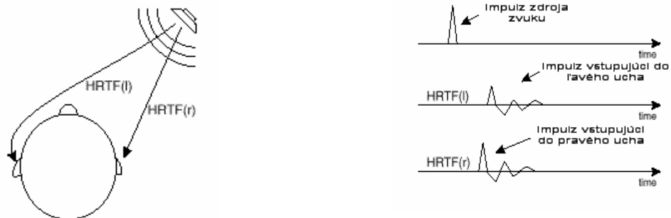
Obr. 10 HRTF(l) pre ľavé ucho a HRTF(r) pre pravé ucho (vľavo); impulz zo zdroja zvuku najskôr pride do ľavého ucha a potom do pravého ucha o čom svedčia aj posuny týchto impulzov(vpravo) [9].
